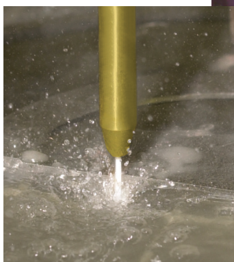
Corte con chorro de agua con presión de 4000 bar y aditivos abrasivos (aproximadamente 500 g de arena por minuto)
